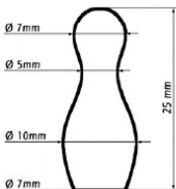
Les quilles ont une hauteur de 25 mm. Leur diamètre est de 7 mm à la tête, de 10 mm à l'endroit le plus large et de 7 mm à la base. Elles sont toutes de forme et de dimensions identiques.
